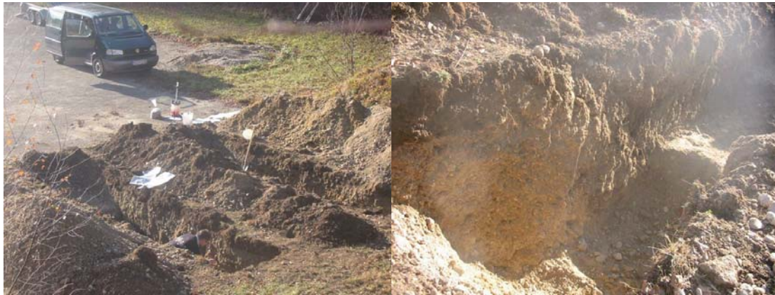
Abb. A4-2a und b: Schurfgruben am Standort „Zufahrt Schießplatz der UniBwM“ (UniSd-Sch1 und UniSd-Sch2)
