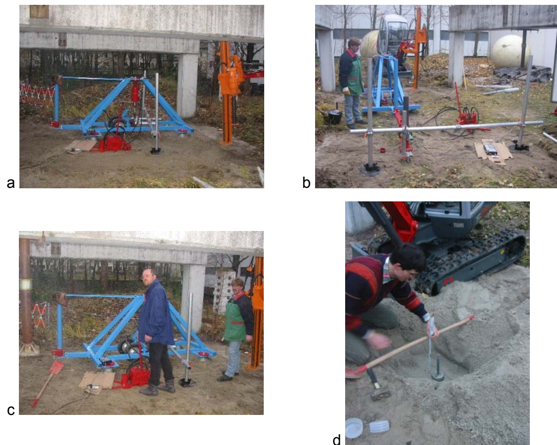
Abb. A9-4a bis d: Versuche auf dem Freigelände der UniBwM in Neubiberg zwischen den dort bestehenden Beton-Widerlagerbalken (Standort „UniF“): Ansicht von Süden (a), von Westen (b), während der Prüfung eines SF in zentrischer Richtung (c), Bestimmung der Trockendichte mit Stechzylinder und Densitometer (d)
